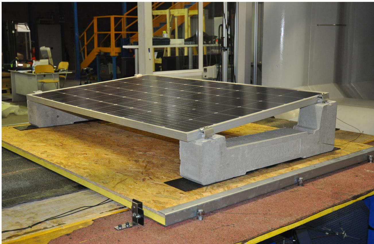
Il pannello di legno (dimensioni 200cmX200cm) è supportato da n. 4 celle di carico LAUMAS CK500 con fondo scala 500 kg aventi errore massimo combinato inferiore allo 0,5%
