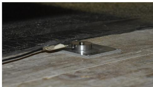
Il pannello di legno è libero lungo il movimento orizzontale: il vincolo viene realizzato mediante un cuscinetto a sfera che limita esclusivamente l'eventuale movimento trasversale al vento.
