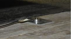
Il pannello di legno è libero lungo il movimento orizzontale: il vincolo viene realizzato mediante un cuscinetto a sfere che limita esclusivamente l'eventuale movimento trasversale al vento.
