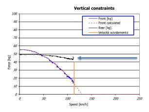
Nella rielaborazione dei risultati interpolando i valori di forza misurati è possibile andare a dedurre teoricamente quale possa essere la velocità di potenziale inizio sollevamento, ovvero la velocità alla quale la forza scaricata sul piano di appoggio frontale della zavorra scende a zero.
