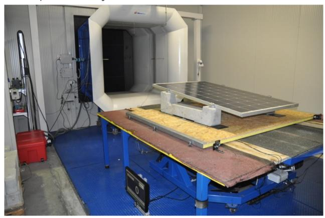
Il pannello di legno (dimensioni 200cmX200cm ) è supportato da n. 4 celle di carico LAUMAS CK500 con fondo scala 500 kg aventi errore massimo combinato inferiore allo 0,5%
